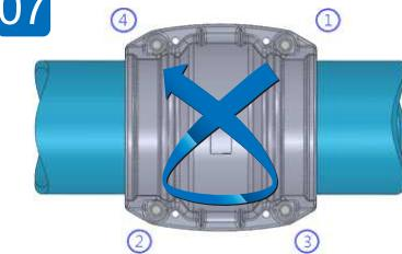
Para uma montagem eficaz, aperte os parafusos em um padrão "X". Para desmontar, execute a mesma operação na ordem inversa.
