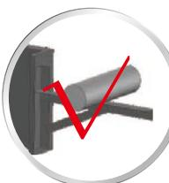
Para tubulações de grande diâmetro (DN100 a DN200), a fixação do suporte pode ser feita por soldagem na viga de aço, desde que respeitadas as normas de segurança da estrutura.
