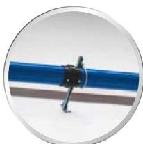
Para permitir a dilatação térmica do tubo, é necessário fixar corretamente os clips de sustentação à parede. Todos os clips AIRpipe devem ser instalados utilizando parafusos M8.
