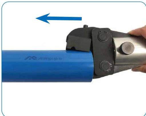
Abra manualmente as garras da braçadeira da máquina e insira o tubo de alumínio até o limite máximo permitido pela mandíbula.
