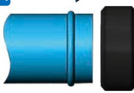
Deslize a vedação sobre a extremidade do tubo até que fique nivelada com a borda saliente. Certifique-se de que a vedação esteja bem posicionada.
