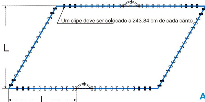
**A2) Tubulação multiloop para DN40-DN100**
