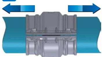
Puxe o tubo de volta para a parte externa da concha para completar o alinhamento.
