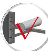
Para tubulações de grande diâmetro (DN100 a DN200), a perfuração da viga de aço pode ser utilizada como método de fixação, desde que esteja em conformidade com os critérios estruturais do projeto.
